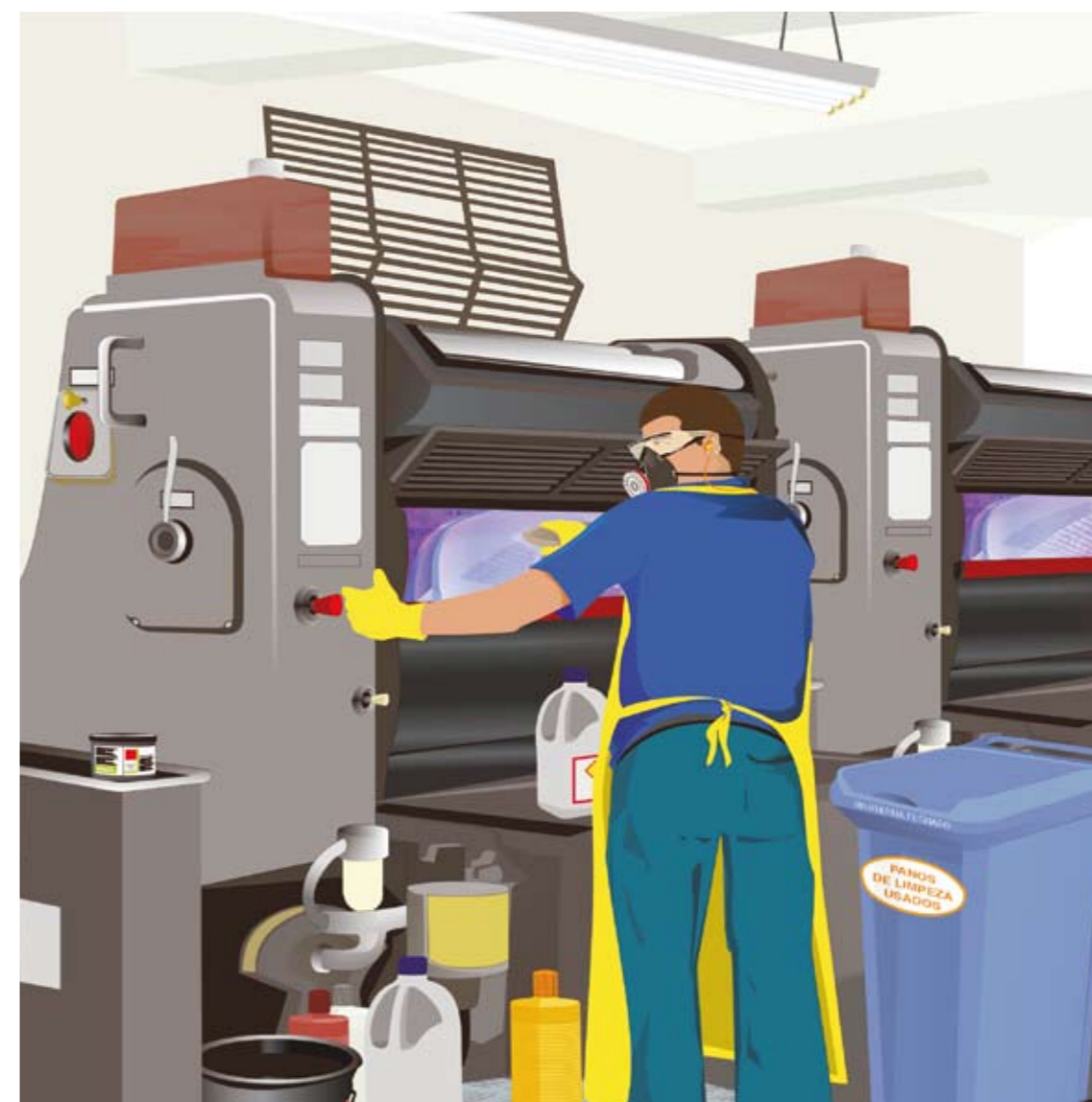
FIGURA 21 roteiro de limpeza dos rolos das máquinas
