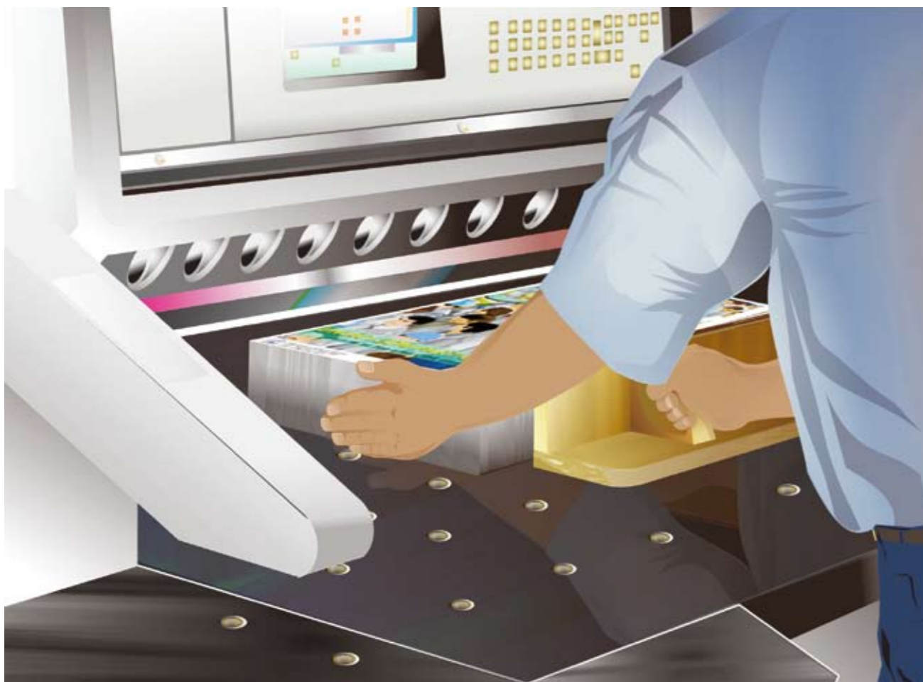
FIGURA 20 utilização de empurrador na guilhotina
